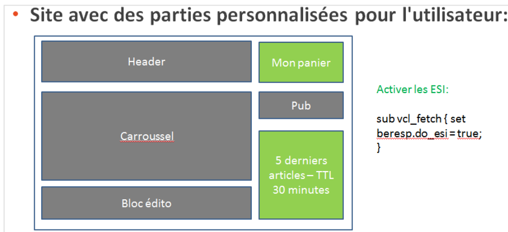
Fig. 10. Structure de site utilisant des includes ESI
