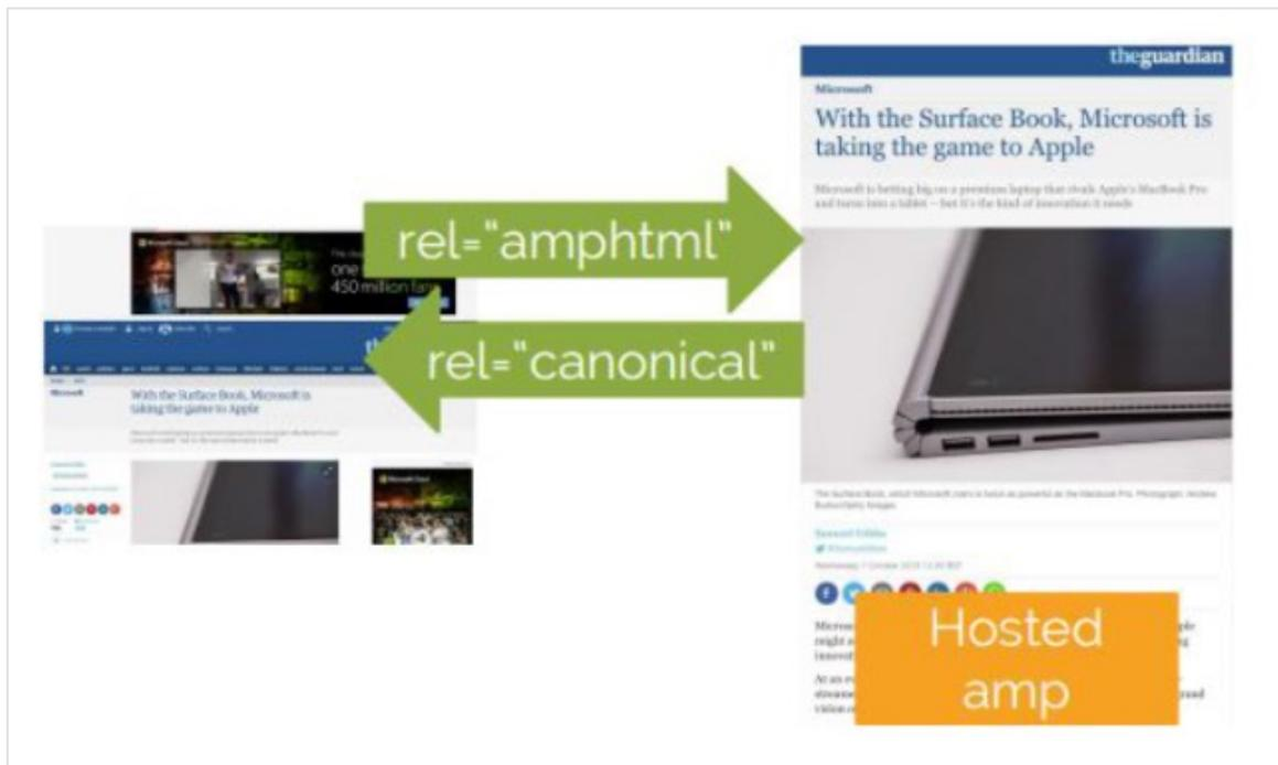
Fig.5. Une illustration issue d'une présentation de Distilled, montrant le rôle des balises rel='amphtml' et rel='canonical' pour relier les pages normales et leur version amphtml
